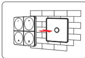
6. Posizionare l'interruttore rotante sulla parte anteriore del supporto
