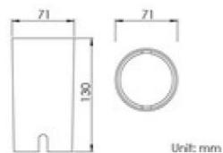
Cassa di fondazione per installazioni nel terreno (dimensione: D71mm)
