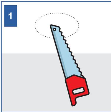
**1** Effettuare un foro dal diametro di 50mm nel soffitto in cartongesso, nella posizione prescelta.
