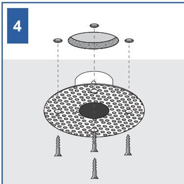
**4** Fissare la controcassa per cartongesso utilizzando le apposite viti autofilettanti.
