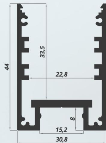
Profilo dissipatore led in alluminio
